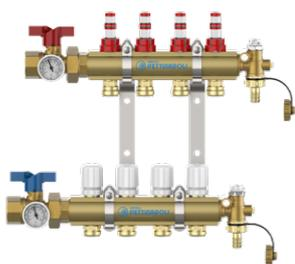
Kit completo de colector premontado y probado en Pettinaroli fabricado en latón. El kit **incluye** las dos **unidades terminales** con venteo manual y desague, **las dos válvulas de corte con salida 1" H**, **termómetros (T39P/80)** y **caudalímetros**. Caudal: desde 1 l/min hasta 5 l/min.
