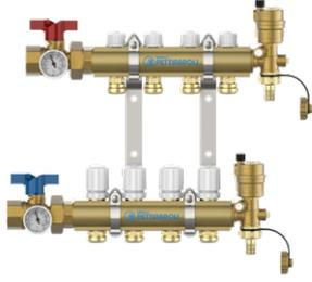
Kit completo de colector premontado y probado en Pettinaroli fabricado en latón. El kit **incluye** las dos **unidades terminales** con venteo automático y desague, **las dos válvulas de corte con salida 1" H** y **los termómetros (T39P/80)**.
