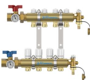
Kit completo de colector premontado y probado en Pettinaroli fabricado en latón. El kit **incluye** las dos **unidades terminales** con venteo manual y desague, **las dos válvulas de corte con salida 1" H** y **los termómetros (T39P/80)**.
