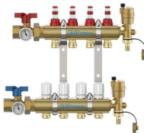
Kit completo de colector premontado y probado en Pettinaroli fabricado en latón. El kit **incluye** las dos **unidades terminales** con venteo automático y desague, **las dos válvulas de corte con salida 1" H**, **termómetros (T39P/80)** y **caudalímetros**. Caudal: desde 1 l/min hasta 5 l/min.
