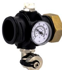
**Unidad terminal** en polímero PA66 y latón compuesto por un terminal en "T", un **purgador de aire manual**, un desagüe y un termómetro. Disponible con rosca de entrada de 1" o 1 1/4".
