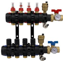
Kit completo de colector MODUSYS premontado y probado en Pettinaroli fabricado en PA66 y accesorios en latón. El kit incluye las dos unidades terminales con venteo automático y desague, las dos válvulas de corte con salida 1" H, termómetros (T39P/80) y caudalímetros. Caudal: desde 1 l/min hasta 5 l/min.
