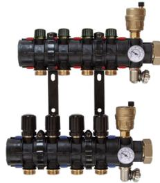
Kit completo de colector MODUSYS premontado y probado en Pettinaroli fabricado en PA66 y accesorios en latón. El kit incluye las dos unidades terminales (rosca de Ø 1" H asiento llano) con venteo automático y desague y termómetros (T39P/80).
