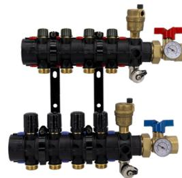
Kit completo de colector MODUSYS premontado y probado en Pettinaroli fabricado en PA66 y accesorios en latón. El kit incluye las dos unidades terminales con venteo automático y desague, las dos válvulas de corte con salida 1" H y los termómetros (T39P/80).
