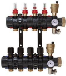
Kit completo de colector MODUSYS premontado y probado en Pettinaroli fabricado en PA66 y accesorios en latón. El kit incluye las dos unidades terminales (rosca de Ø 1" H asiento llano) con venteo automático y desague, termómetros (T39P/80) y caudalímetros. Caudal: desde 1 l/min hasta 5 l/min.
